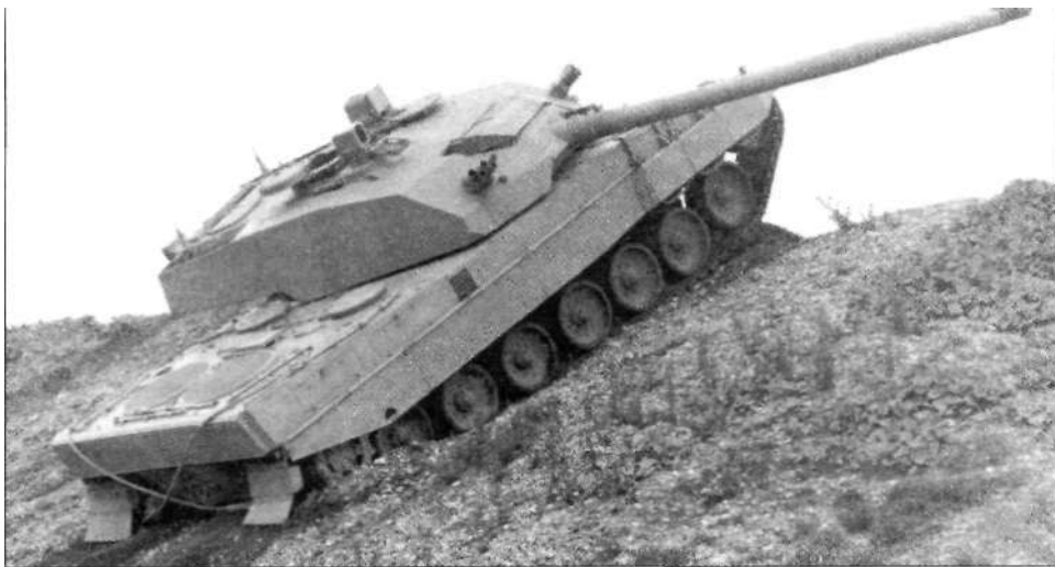
«Виккерс» Mk.7 преодолевает подъем во время полигонных испытаний. 1987 год
