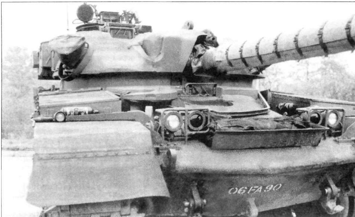
На обоих снимках — танк «Чифтен» Mk.11/1 с дополнительной накладной броневой защитой «Стиллбрю»
