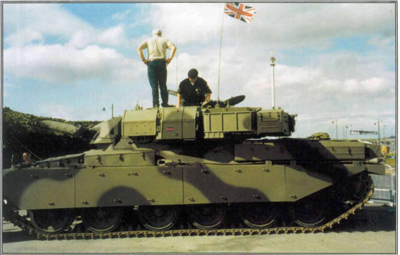
Основной боевой танк «Чифтен» Mk 11/1 на выставке боевой техники в г. Чатэм (Великобритания) в 2002 году. Обращают на себя внимание двухцветный камуфляж машины, дополнительное бронирование лобовой части башни «Стиллбрю» и более компактный, чем у танков ранних выпусков, ИК-прожектор
